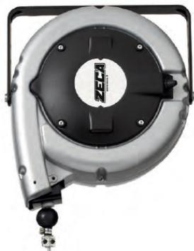
Le Rotolift est équipé d'un dispositif de butée de câble et il permet d'enrouler un câble en acier sur lequel peuvent être suspendus des objets qui sont abaissés sur la surface de travail uniquement pendant la durée d'utilisation. Après l'utilisation, ces objets peuvent être soulevés au-delà de la zone de travail en desserrant le dispositif de blocage. Le câble en acier (ø 3 mm) est revêtu d'une gaine en nylon transparent ø 6 mm.
